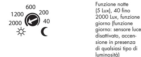
**Avvertenza:** La luminosità può essere verificata in modalità test. Per tale scopo selezionare la funzione di «Test» (vedi «Messa in funzione/Impostazione: Temporizzazione») quindi ruotare la vite di regolazione dalla «luna nera» verso il «sole». La luminosità attuale è ottenuta non appena si spegne il LED verde.
