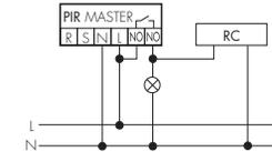
Per la commutazione con lampade fluorescenti, trasformatori, ecc. è eventualmente necessario l'uso di un circuito RC.
