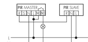
Aumento del campo d'azione con l'impiego di uno o più apparecchi Slave. Attenzione: L'apparecchio Master deve essere sempre montato in un posto dove la luce del giorno è minima.
